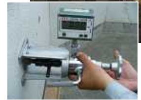
タイル打診検査と塗膜付着力試験
